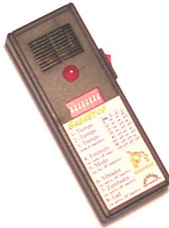
Figura 4 Última versión del temporizador desarrollado por Antonio Atares del Instituto de Robótica de la UVEG.
