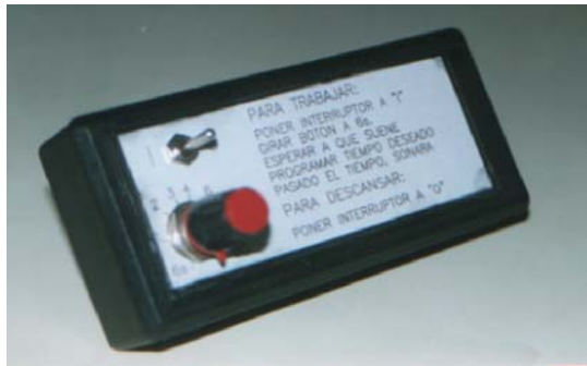
Figura 2. Prototipo inicial de Baba-Stop diseñado y desarrollado por F. Alcantud
